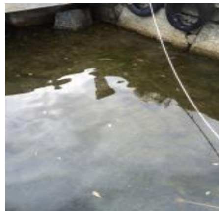
Lina i Vaxholm med minimal mängd alger . BioAq strukturerare höll linorna relativt rena under försöksperioden.
